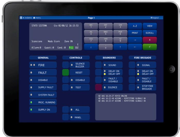
HSYCO costituisce lo strumento di supervisione ideale per progetti complessi, grazie alla sua ineguagliata capacità di interfacciarsi contemporaneamente con più centrali di rilevazione incendio, anche di produttori diversi
